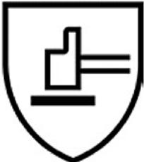
Der Schutz vor mechanischen Risiken wird in der aktuellen DIN-EN 388:2016 geregelt und umfasst Leistungsstufen für Abriebfestigkeit, Schnittfestigkeit mit dem Coupe-Test (Rundklinge), Weiterreißkraft, Durchstichkraft, Schnittfestigkeit nach TDM-Test (Langklinge nach EN ISO 13997) sowie optional für den Stoßschutz.
